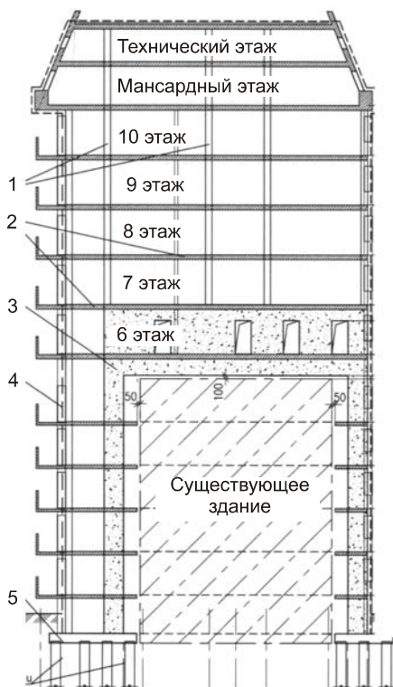
Рис. 1.2. Принципиальная схема конструктивных решений ДВЗ
