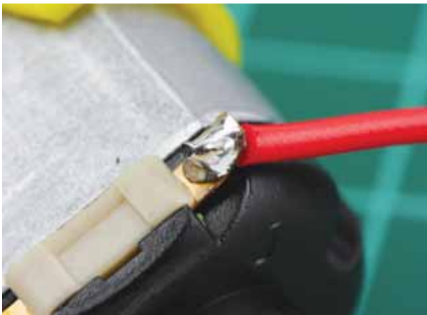
Рис. П4.10. Провод припаян к выводу двигателя. Обратите внимание на блестящую поверхность и коническую форму капли припоя
