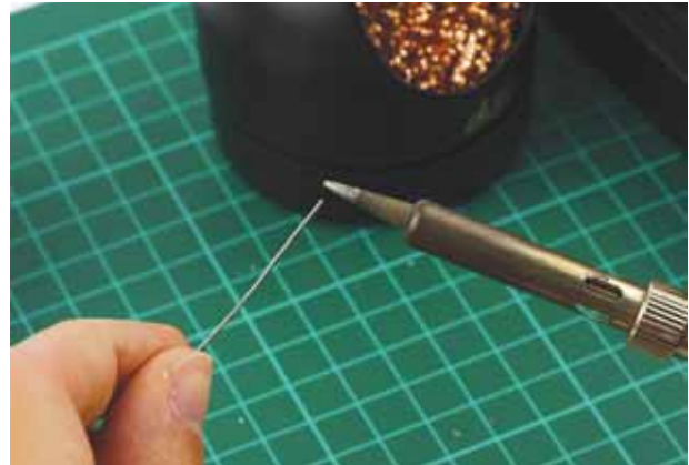
Рис. П4.8. Лужение жала паяльника
