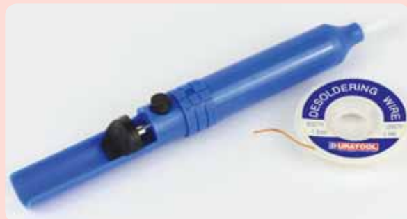
Рис. П4.6. Вакуумный удалитель припоя (слева) и медный впитывающий фитиль (справа)
