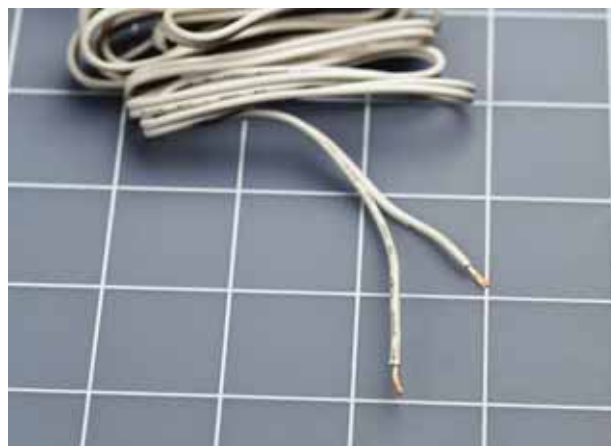
Рис. 3.46. Второй этап: концы проводов зачищены
