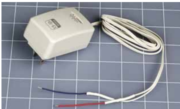
Рис. 3.47. Теперь адаптер подойдет для подачи питания на макетную плату
