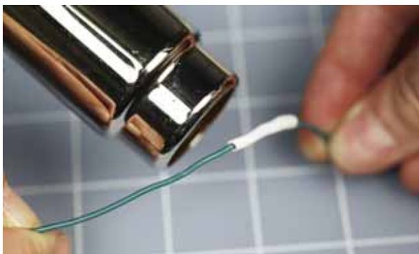
Рис. 3.43. Нагревайте трубку до тех пор, пока она не сожмется, плотно охватив соединение
