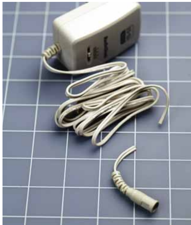
Рис. 3.45. Первый этап переделки сетевого адаптера: вилка отрезана
