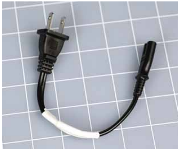
Рис. 3.61. Готовый сетевой шнур
