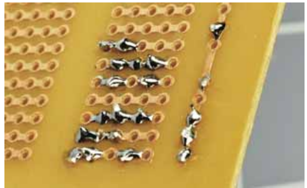
Рис. 4.50. После пайки выводы отрезают, а соединения проверяют под увеличительным стеклом. Теперь можно вставить следующие два или три компонента и продолжить монтаж
